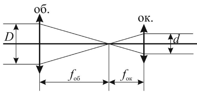
В телескопі задній фокус об'єктива співпадає з переднім фокусом окуляра. Оскільки розглядається віддалена точка, то можна вважати, що на об'єктив падає паралельний пучок променів і з окуляра виходить теж паралельний пучок.
